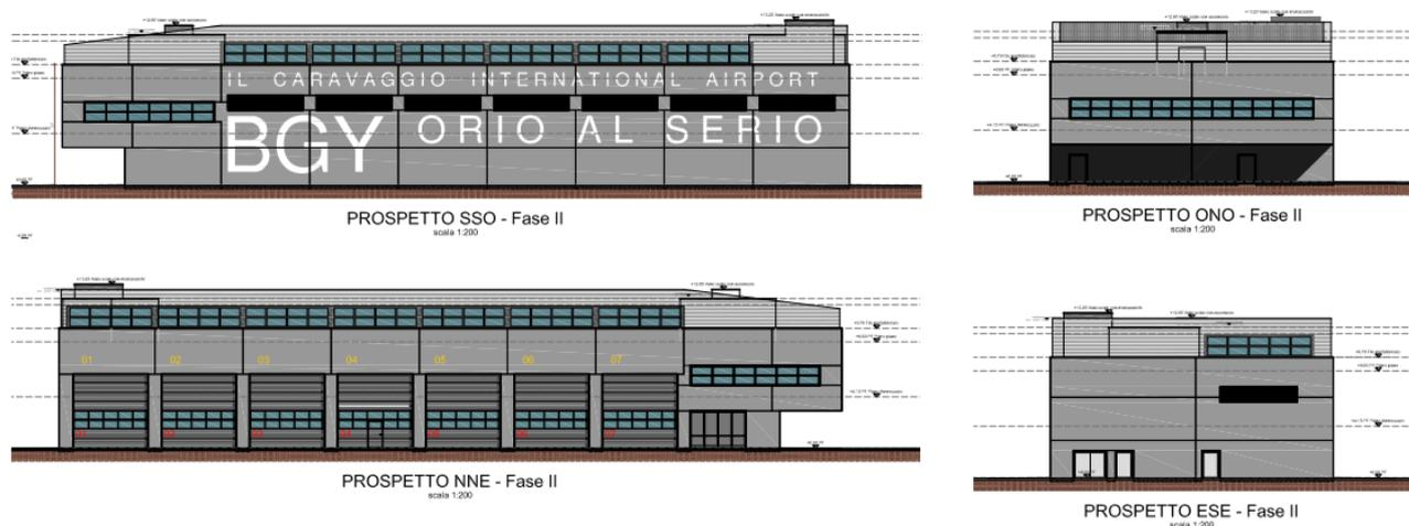
Figura 3-33 Intervento C1: Strutture servizi aviation, prospetti
