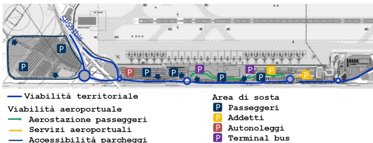
Figura 5-9 Sistema di circolazione interno all'area landside a sud della pista di volo: aerostazione passeggeri, servizi aeroportuali e parcheggi di sosta secondo il layout 2030
