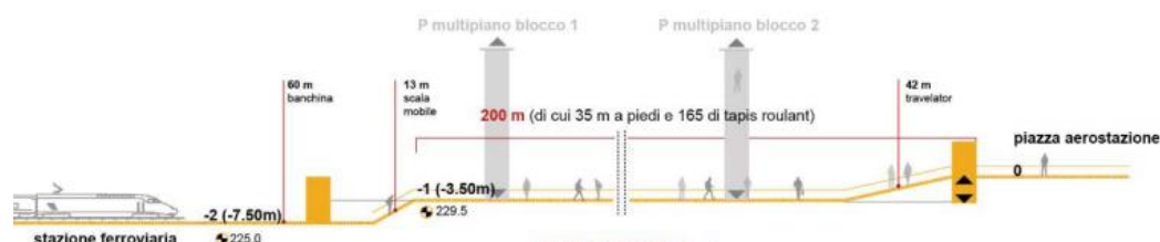
Figura 1-6 Intervento A1: Collegamento sotterraneo stazione ferroviaria, layout
