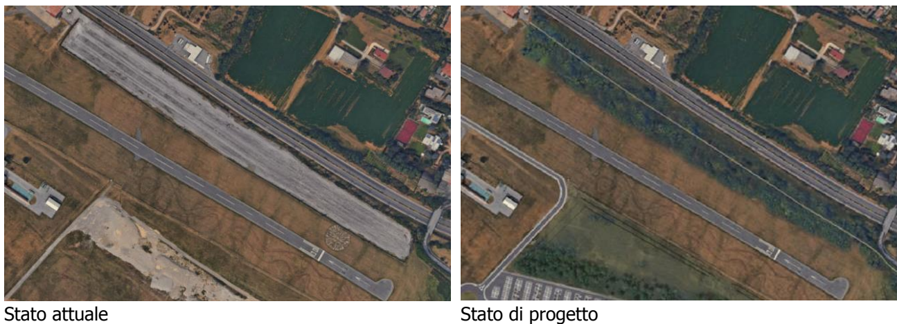
Figura 9-5 Deimpermeabilizzazione del parcheggio di pertinenza dell'aeroclub
