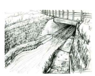
Gli scotolari idraulici sono destinati all'attraversamento di corpi idrici minori intercettati dall'infrastruttura e sono molto adatti ad essere utilizzati come passaggio per la fauna...
