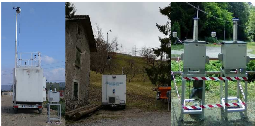
Figura 1. Esempi di laboratorio mobile e campionatore sequenziale
