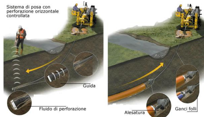
Fig. 1.5 – Posa in opera tubazione per alloggiamento cavi
