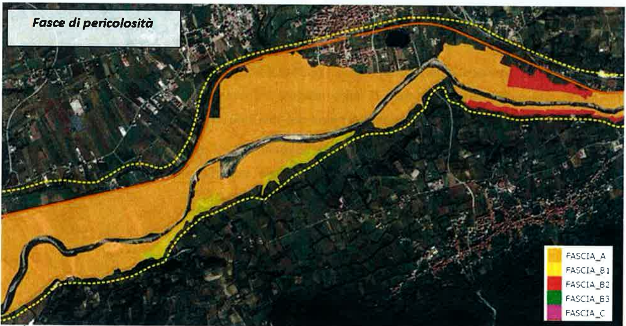
Figura 6-3: confronto tra aree allagate TR 100 anni e fasce PAI tra Paupisi e Solopaca
