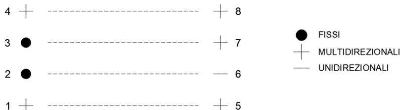
Figura 57: Schema di appoggi impalcato
