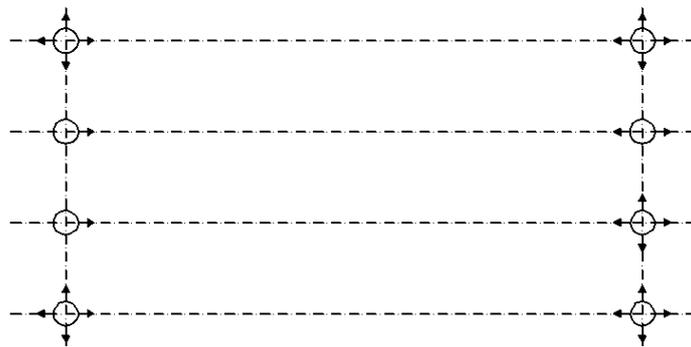
Figura 2—schema di disposizione degli appoggi
