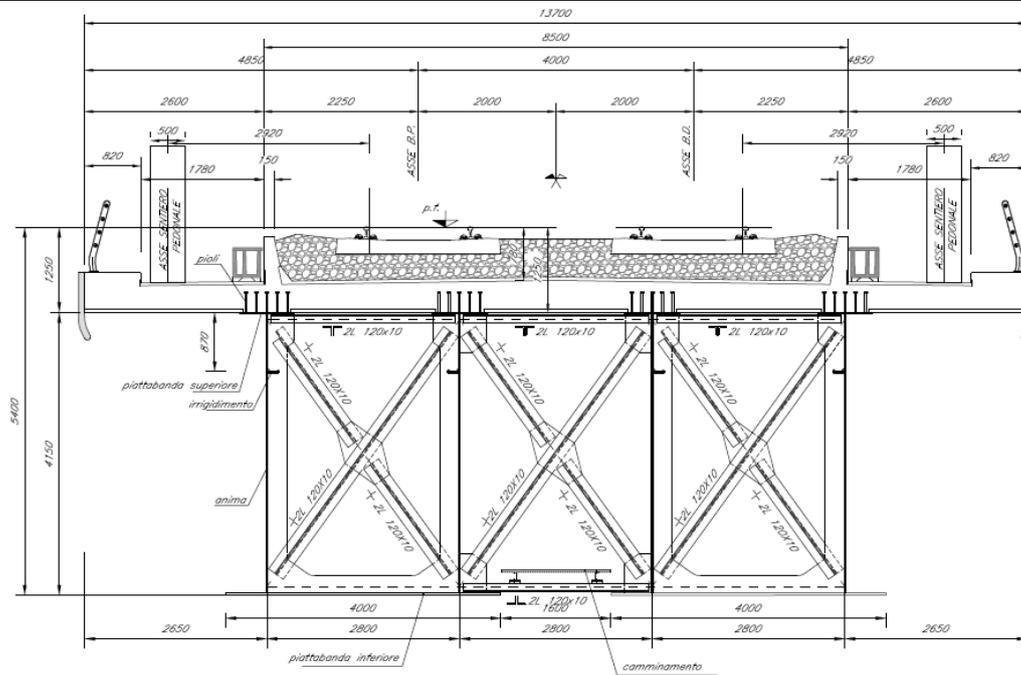
Figura 3: Sezione trasversale tipo (H travi = 4.15 m)
