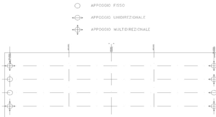
**Figura 5: Schema appoggi**
