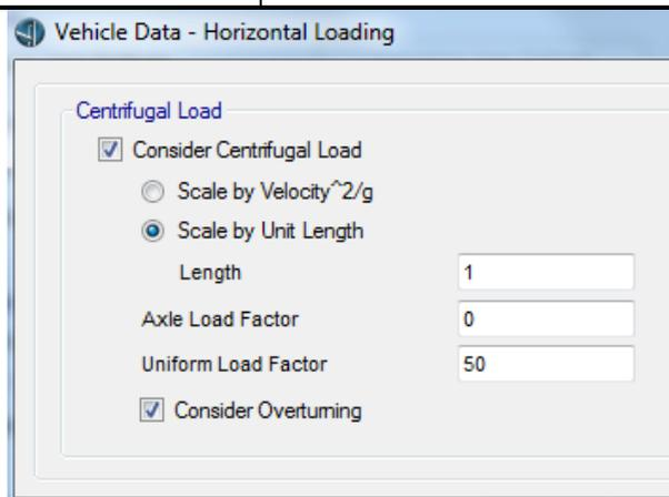
Figura 34: Definizione serpeggio LM71 e SW/2 (q7, q8)
