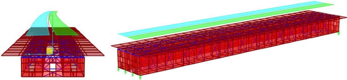
Figura 27: Corsie di carico treni LM71 e SW/2 (q1 e q2)
