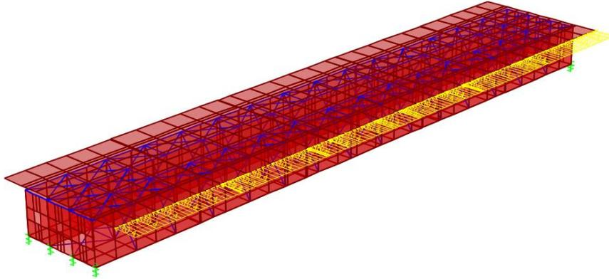
Figura 38: Carico lineare dir y dovuto a vento su barriera
