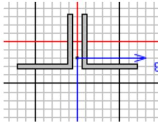
Figura 12: Sezione tipo controventi superiori e briglie superiori e inferiori
