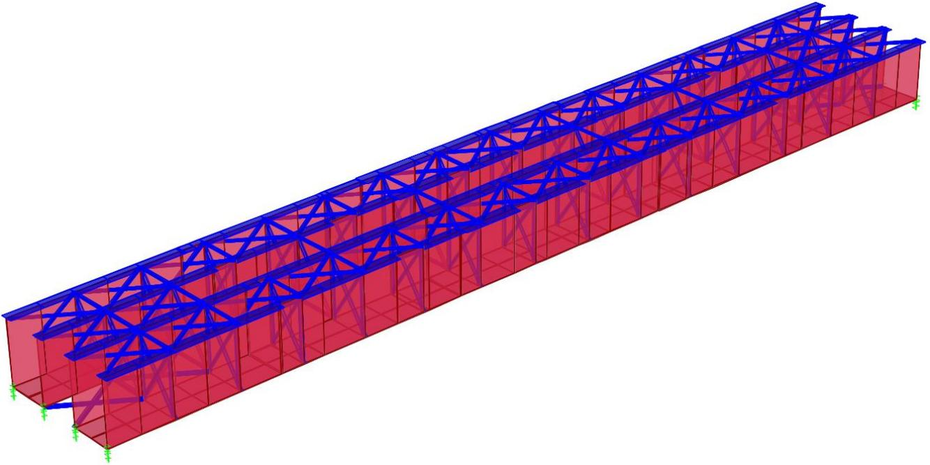
Figura 17: Vista assonometrica estrusa senza soletta e senza diaframmi di testata
