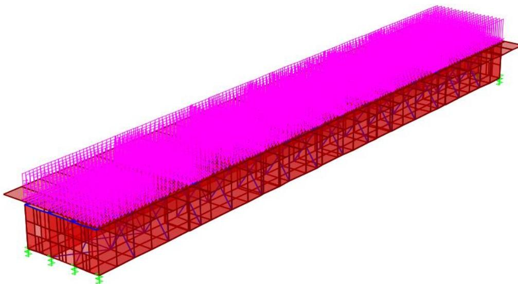
Figura 18: Carico ballast + massetto (g2)
