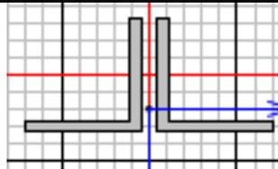
Figura 11: Sezione tipo controventi inferiori
