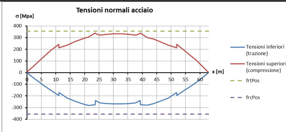
Figura 54: Tensioni normali SLU agenti sulle piattabande superiori e inferiori della trave
