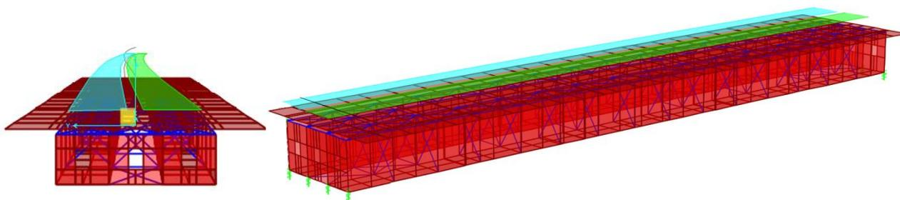
Figura 30: Corsie di carico avviamento LM71 (q3) e frenatura SW/2 (q4)
