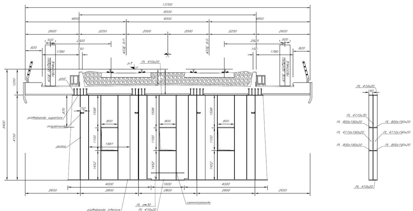
Le verifiche di resistenza sono state condotte in corrispondenza di due sezioni: la prima passante per un pannello non forato, la seconda per il passo d'uomo.
