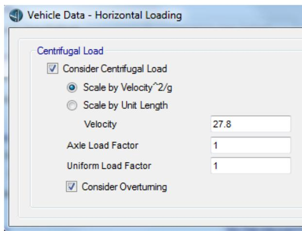
Figura 33: Definizione forza centrifuga SW/2 (q6)
