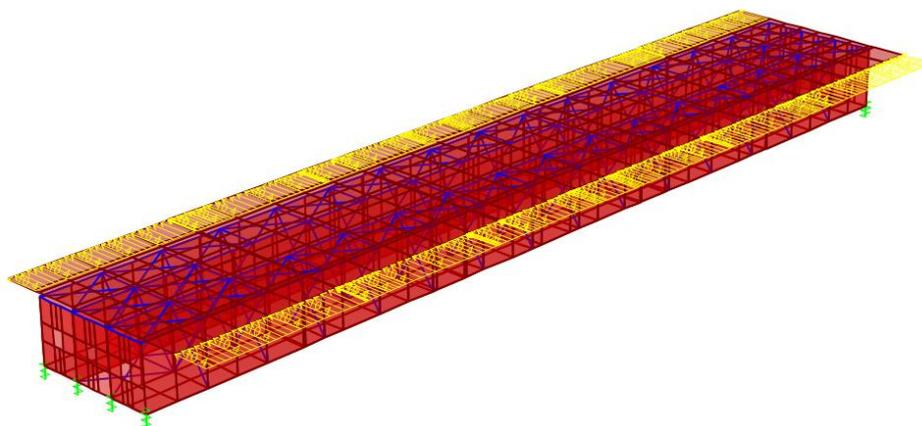
Figura 42: Carichi lineari dir y dovuti a vento su entrambe le barriere
