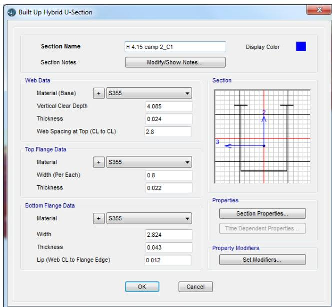
Figura 44: Caratteristiche geometriche della trave in acciaio
