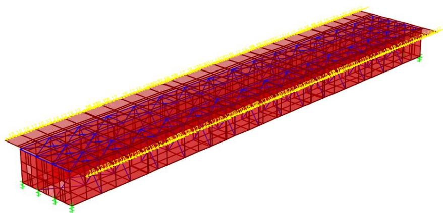
Figura 43: Momenti lineari intorno a x dovuti a vento su entrambe le barriere
