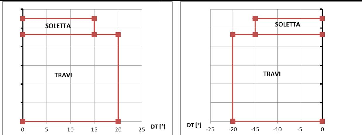
Figura 35: Variazione termica uniforme + differenziale fra soletta e travi (q9, q11)
