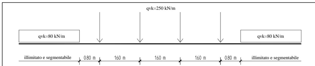
**Figura 6 – Treno di carico LM71**
