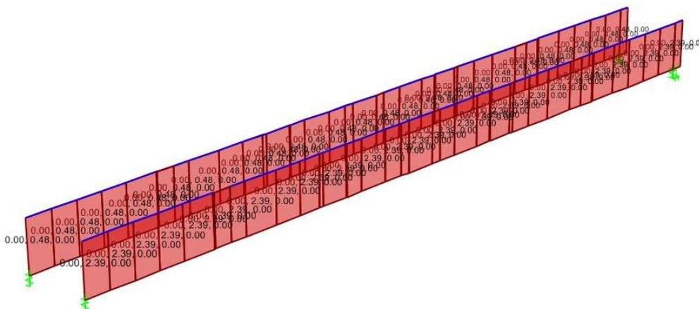
**Figura 37: Carico di superficie dir y dovuto a vento su travi**
