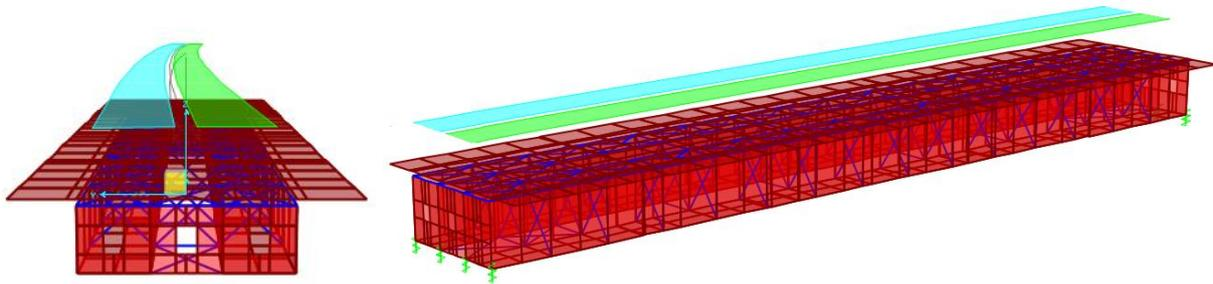
Figura 31: Corsie di carico forze centrifughe (q5 e q6)
