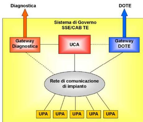
Figura 2 - Architettura generale del SAD computerizzato.
