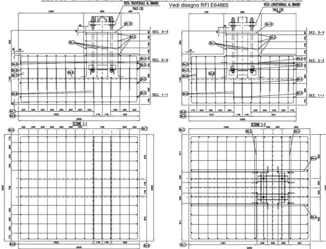
BLOCCO DI FONDAZIONE IN RILEVATO TIPO "B4" - SVILUPPO FERRI DI ARMATURA
