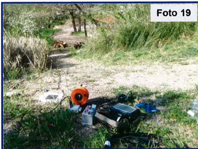
Foto 19-20: Una fase di acquisizione del profilo sismico S17 con metodologia sismica ed elettrica tomografica. Centro strumentale con tombino di sondaggio.
