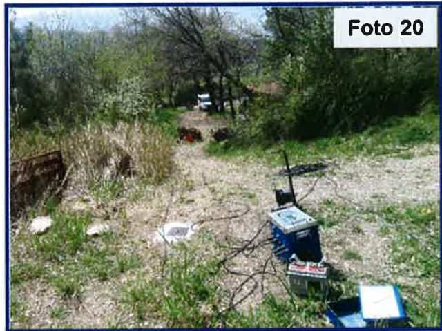
Foto 19-20: Una fase di acquisizione del profilo sismico S17 con metodologia sismica ed elettrica tomografica. Centro strumentale con tombino di sondaggio.
