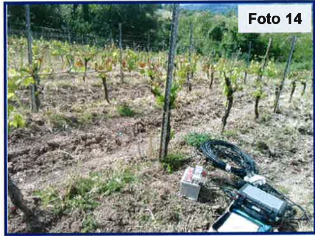
Foto 13-14: Profilo sismico S12; primo cavo 24 geofoni (Foto 13) e secondo cavo 24 geofoni (Foto 14).
