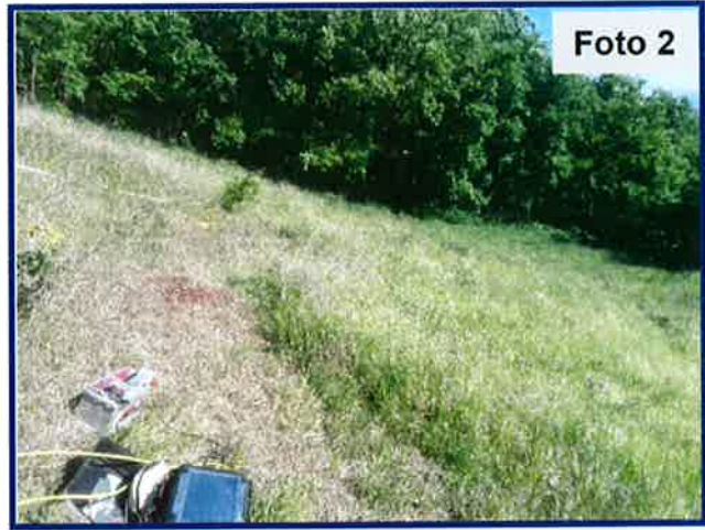
Foto 1-2: Una fase di acquisizione del profilo sismico S6; primo cavo 24 geofoni (Foto 1) e secondo cavo 24 geofoni (Foto 2).
