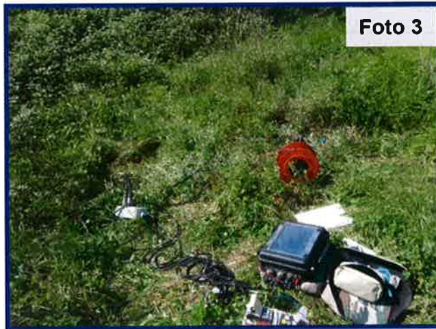
Foto 3-4: Una fase di acquisizione del profilo sismico S7: strumentazione sismica utilizzata (Foto 3); sviluppo della linea verso il rilievo (v. Foto 4) .
