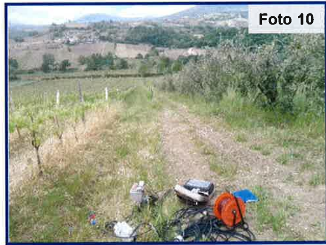
Foto 9-10: Una fase di acquisizione del profilo sismico S10: strumentazione sismica utilizzata; lato monte (Foto 9) e lato valle (Foto 10) .
