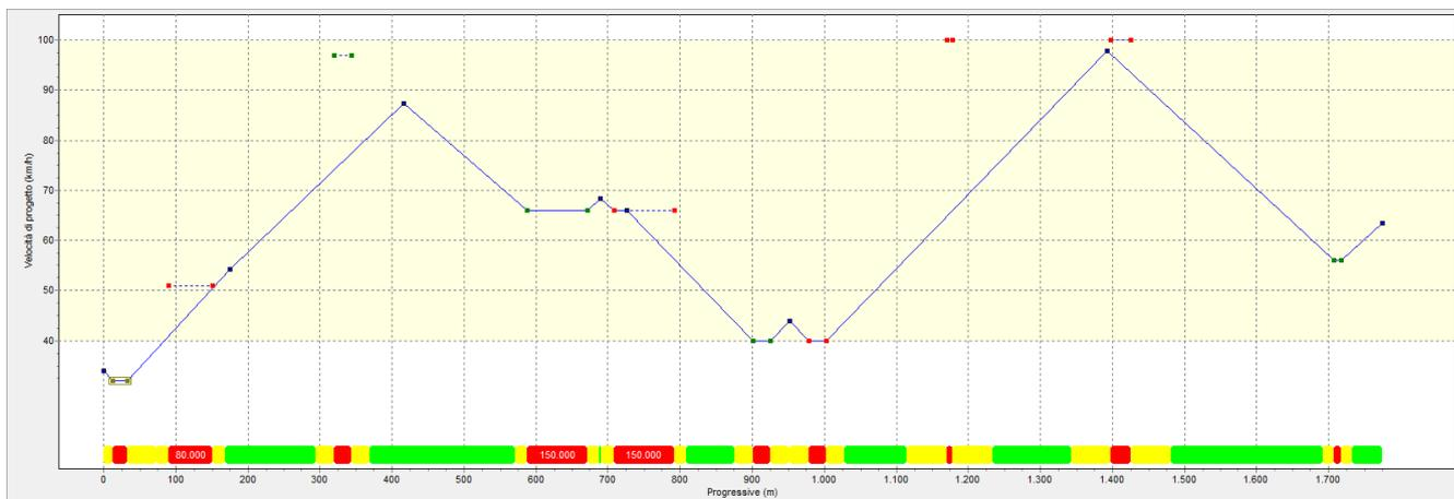
Gli elementi geometrici planimetrici ed altimetrici risultano verificati per un intervallo di velocità di progetto pari a (30 ÷ 40) km/h. Il diagramma corrispondente a tale intervallo è riportato nella figura seguente.
