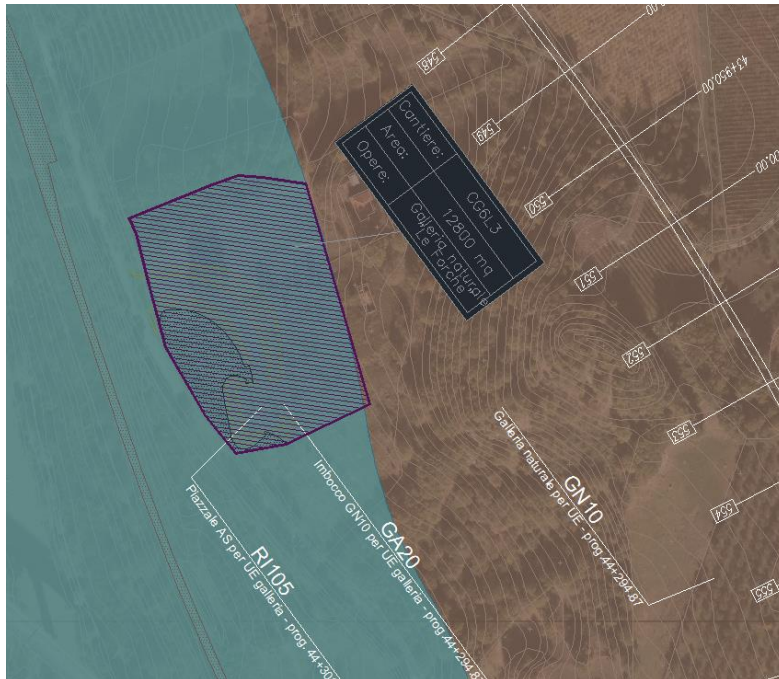
Figura 5-6 – Ortofoto con rappresentato il cantiere galleria CG6L3 che interferisce con la fascia di rispetto del fiume Calore e con il vincolo paesaggistico del PTP del Massiccio del Taburno. Il retino azzurro rappresenta la fascia di rispetto dei corsi d'acqua designata ai sensi dell'art. 142 lett. "c" del Codice; mentre il retino marrone quello del vincolo paesaggistico (art. 136 del D.Lgs 42/2004).
