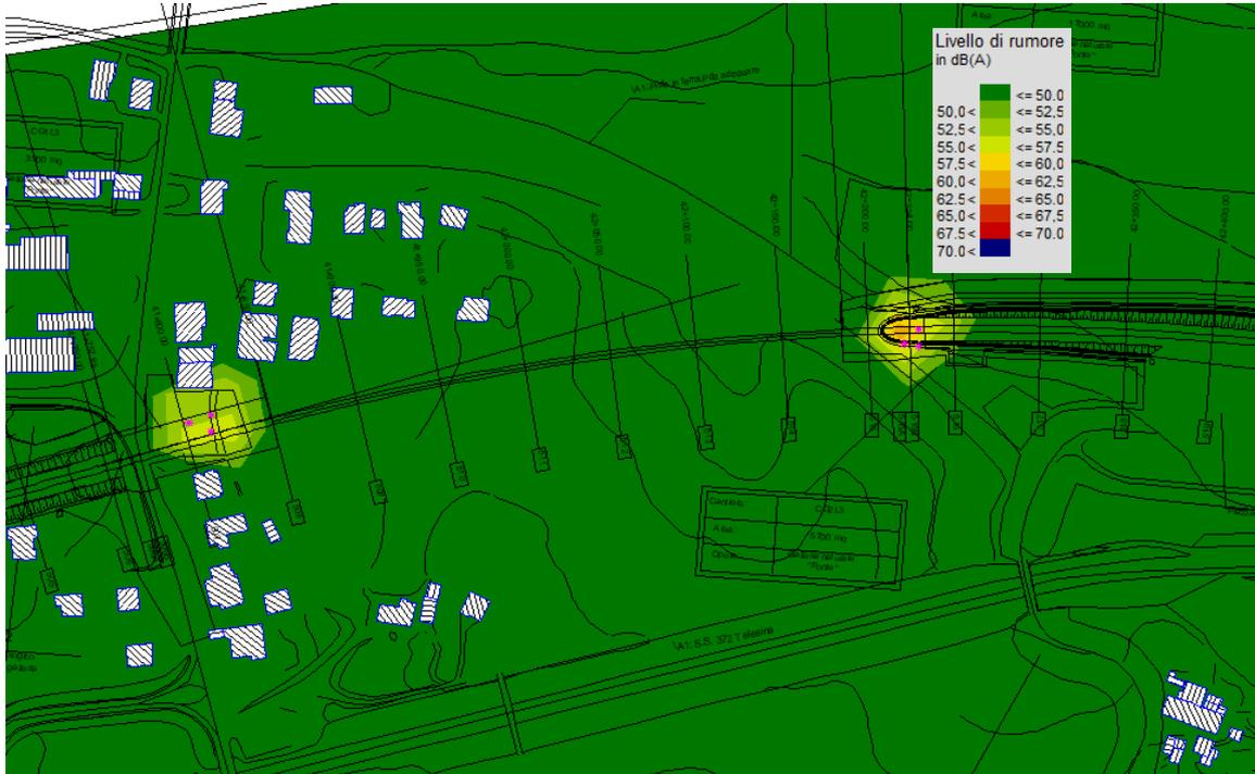
Figura 66. Modello acustico realizzazione CG1L3, DT1L3, CG2L3 – NOTTURNO
