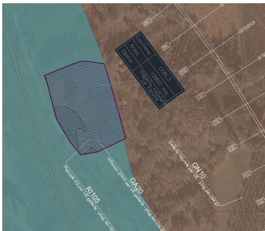
Figura 38. Ortofoto con rappresentato il cantiere galleria CG6L3 che interferisce con la fascia di rispetto del fiume Calore e con il vincolo paesaggistico del PTP del Massiccio del Taburno. Il retino azzurro rappresenta la fascia di rispetto dei corsi d'acqua designata ai sensi dell'art. 142 lett. "c" del Codice; mentre il retino marrone quello del vincolo paesaggistico (art. 136 del D.Lgs 42/2004).
