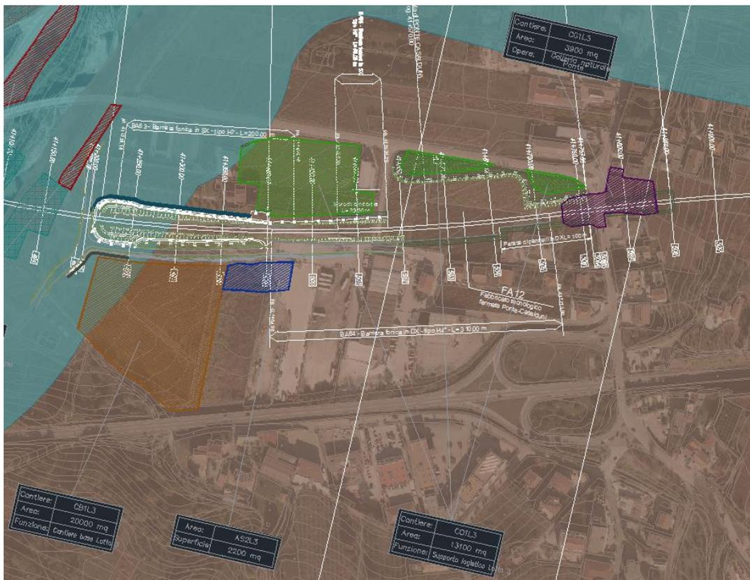
Figura 34. Ortofoto con rappresentate le aree di cantiere che interferiscono con la fascia di rispetto del fiume Calore e con il vincolo paesaggistico del PTP del Massiccio del Taburno, in prossimità di Ponte. Il retino azzurro rappresenta la fascia di rispetto dei corsi d'acqua designata ai sensi dell'art. 142 lett. “c” del Codice; mentre il retino marrone quello del vincolo paesaggistico (art. 136 del D.Lgs 42/2004).
