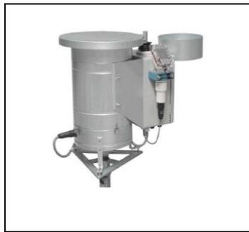
Tale apparecchio si attiva in assenza di precipitazioni raccogliendo il materiale sedimentato. Quest'ultimo viene poi valutato per microscopia ottica automatica dopo essere stato raccolto su adeguato vetrino di osservazione. La foto di seguito riportata si riferisce ad un campione di particolato atmosferico sedimentato.
