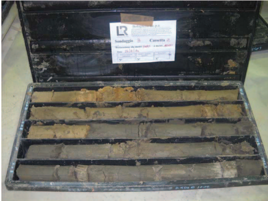
Foto N°14: sondaggio S3 OS09 Palo 23 Cassetta C2 da 5,00 a 10,00 m
