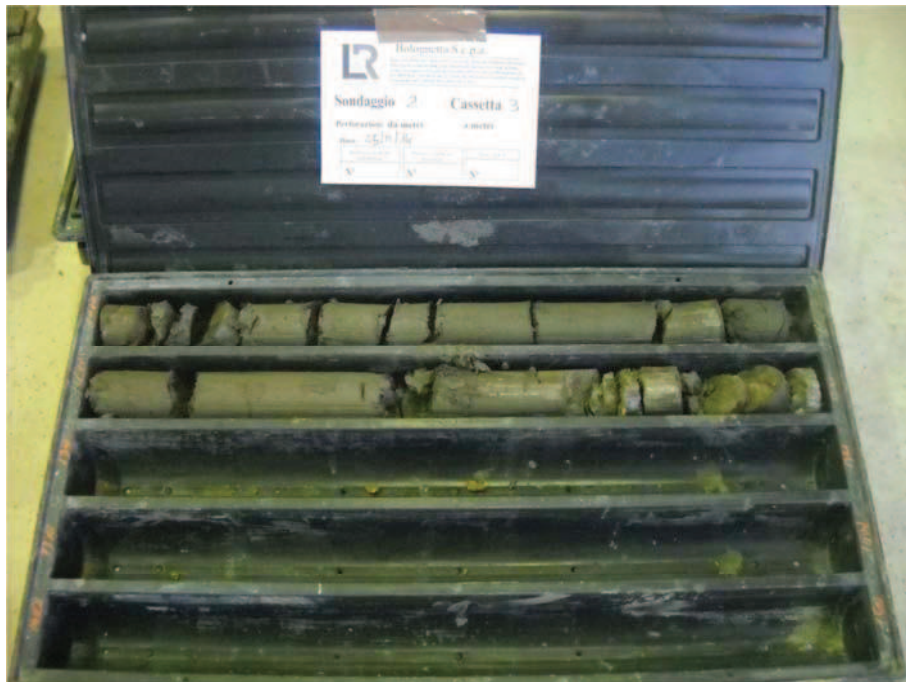
Foto N°9: sondaggio S2 OS09 Palo 33 Cassetta C3 da 10,00 a 12,00 m
