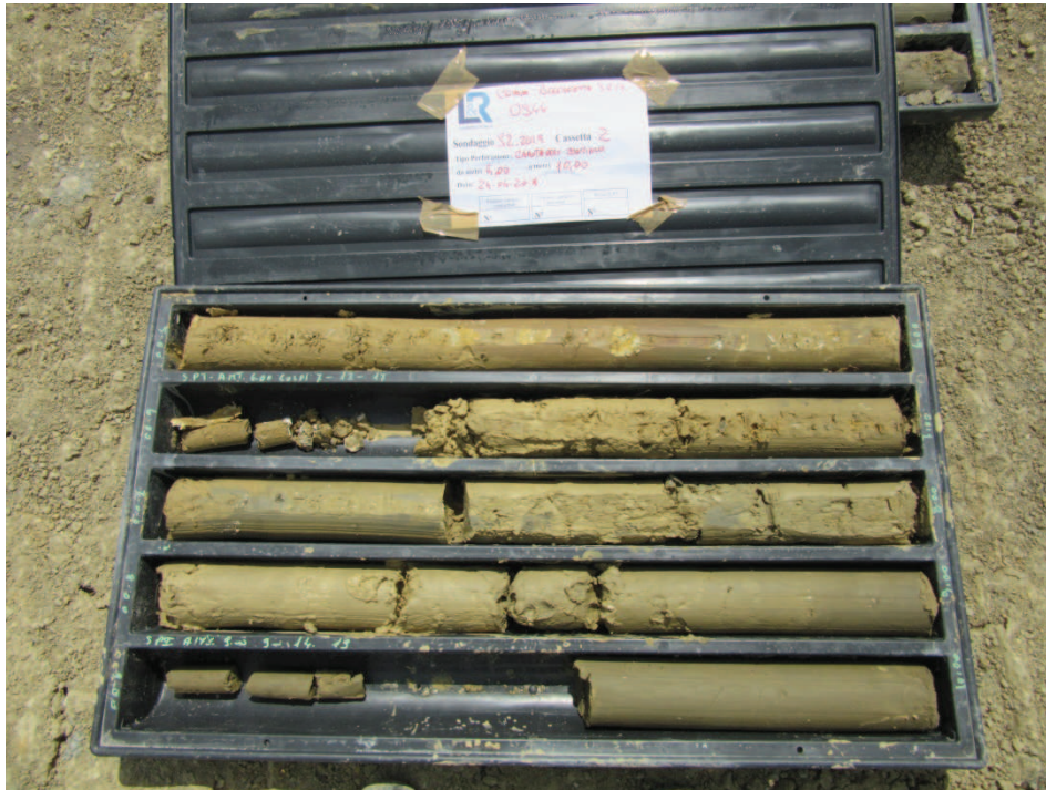
Foto N°3: S2_2015_OS44 Cassetta C2 da 5,00 a 10,00 m
