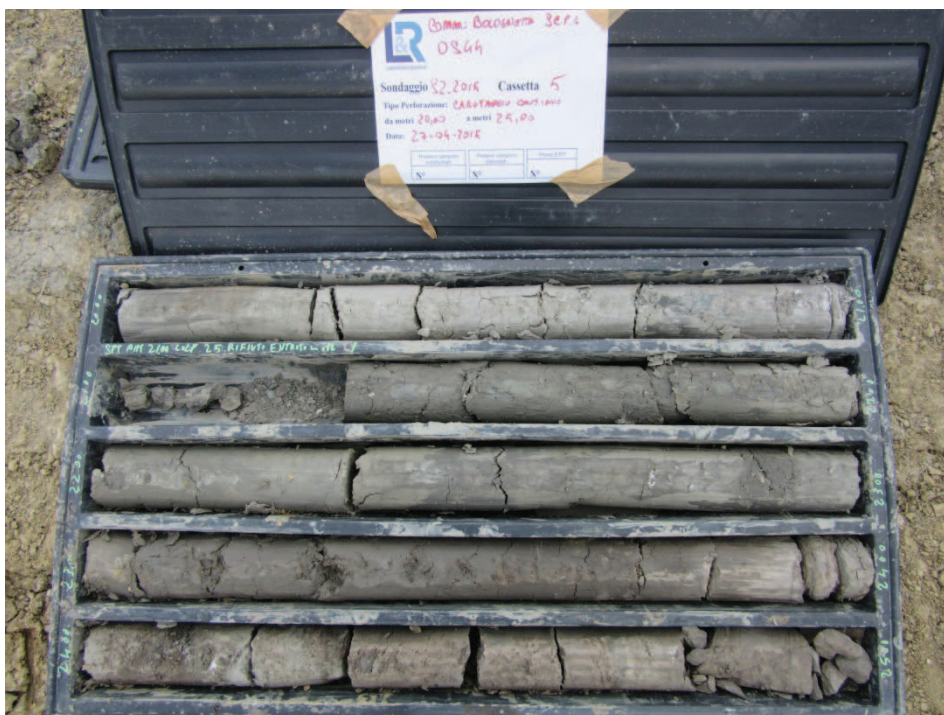
Foto N°5: S2_ 2015_ OS44 Cassetta C5 da 20,00 a 25,00 m
