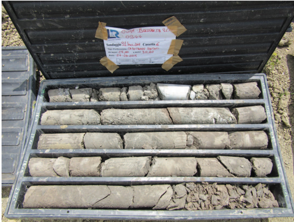
Foto N°7: SIINCL_2015_OS44Cassetta C6 da 25,00 a 30,00 m
