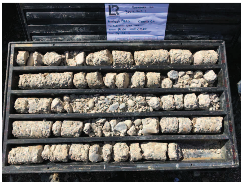
Foto N°5: PILA 3 Cassetta C4 da 15,00 a 20,00 m
