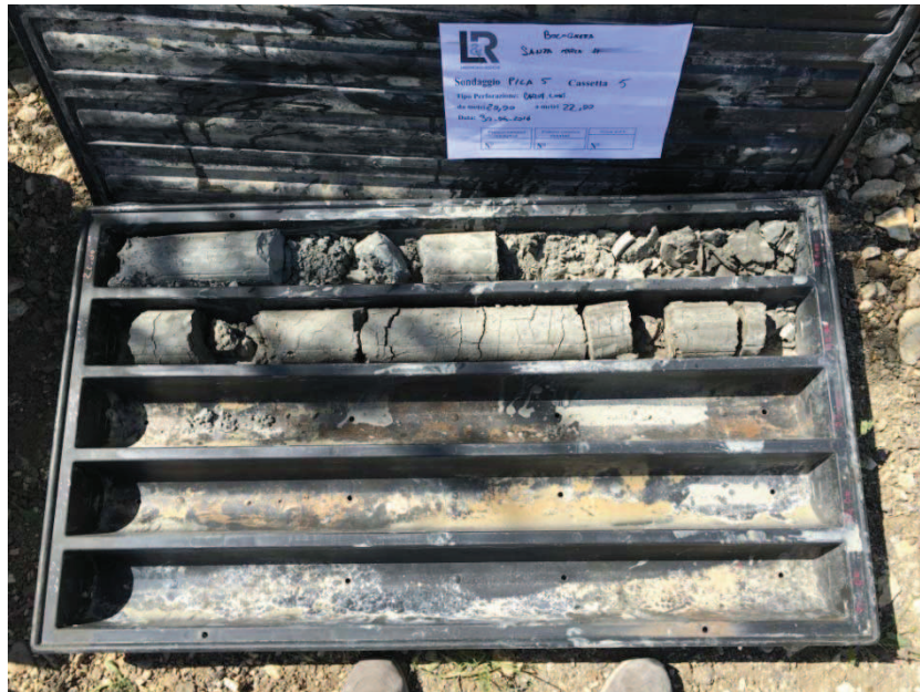
Foto N°5: PILA 5 Cassetta C5 da 20,00 a 22,00 m
