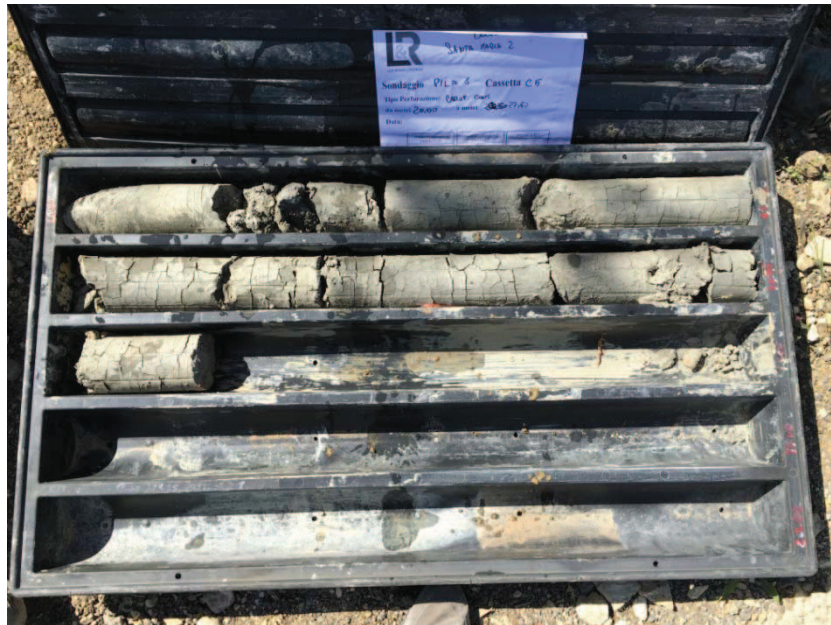
Foto N°6: PILA 8 Cassetta C5 da 20,00 a 22,50 m
