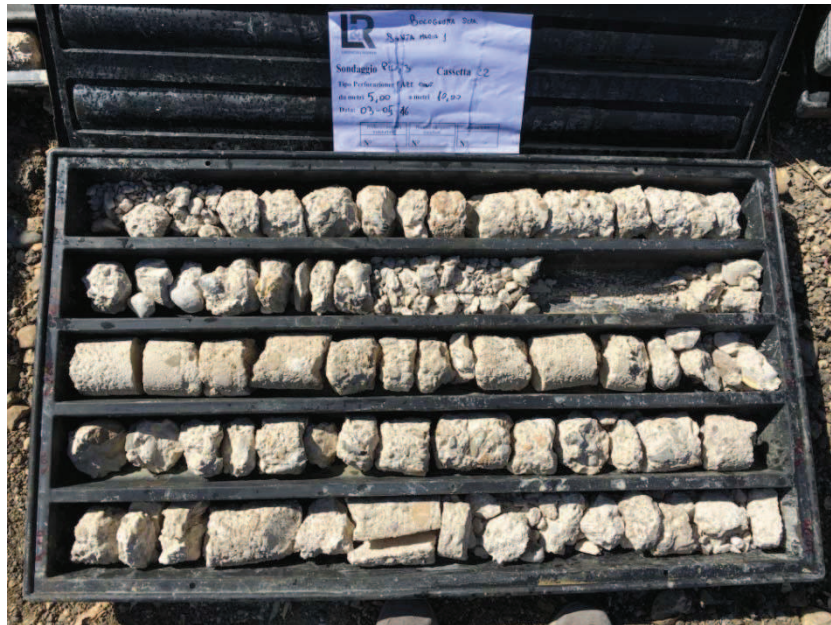
Foto N°3: PILA 3 Cassetta C2 da 5,00 a 10,00 m
