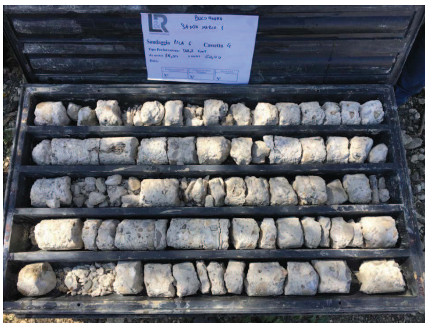
Foto N°5: PILA 6 Cassella C4 da 15,00 a 20,00 m
