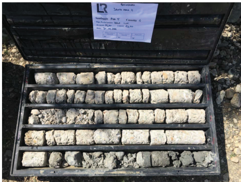
Foto N°5: PILA 5 Cassetta C4 da 15,00 a 20,00 m
