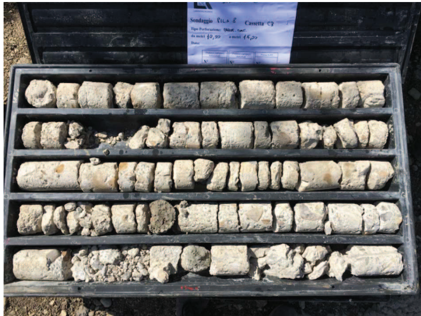
Foto N°4: PILA 8 Cassetta C3 da 10,00 a 15,00 m
