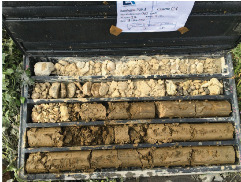
Foto N°2: SGI - Cassetta C1 da 0,00 a 5,00 m
