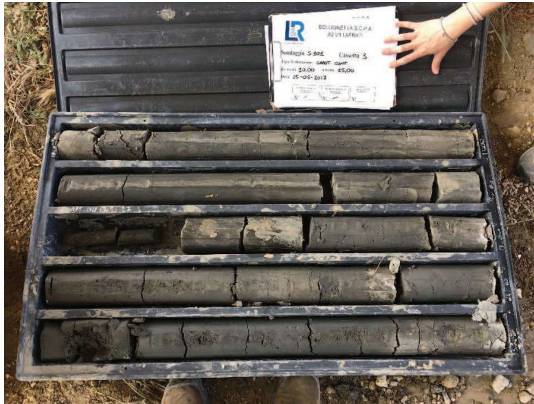
Foto N°4: S101_17 Cassella C3 da 10,00 a 15,00 m
