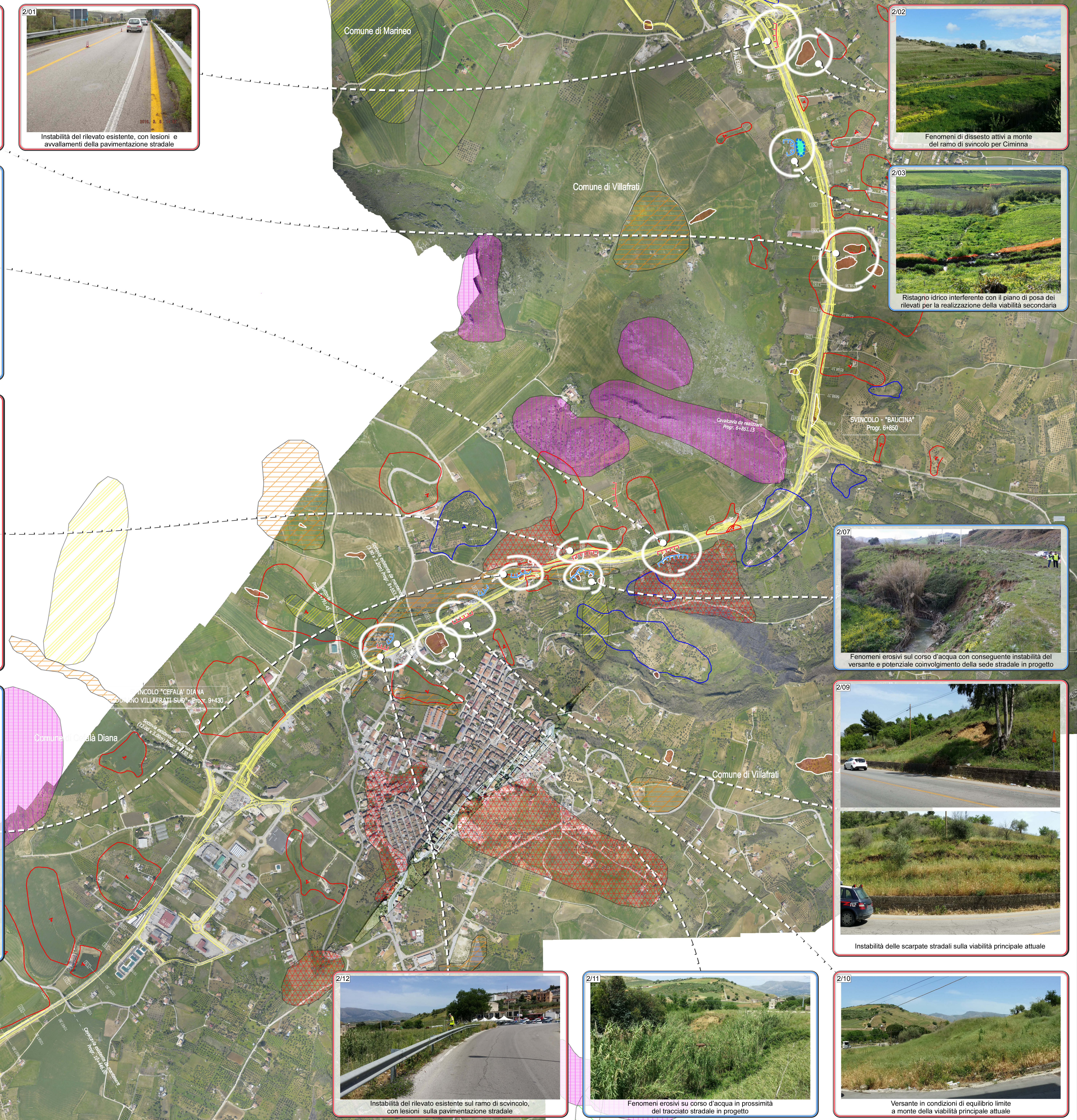
2/04 Fenomeni gravitativi attivi interferenti con la prevista realizzazione di viabilità secondaria in trincea
