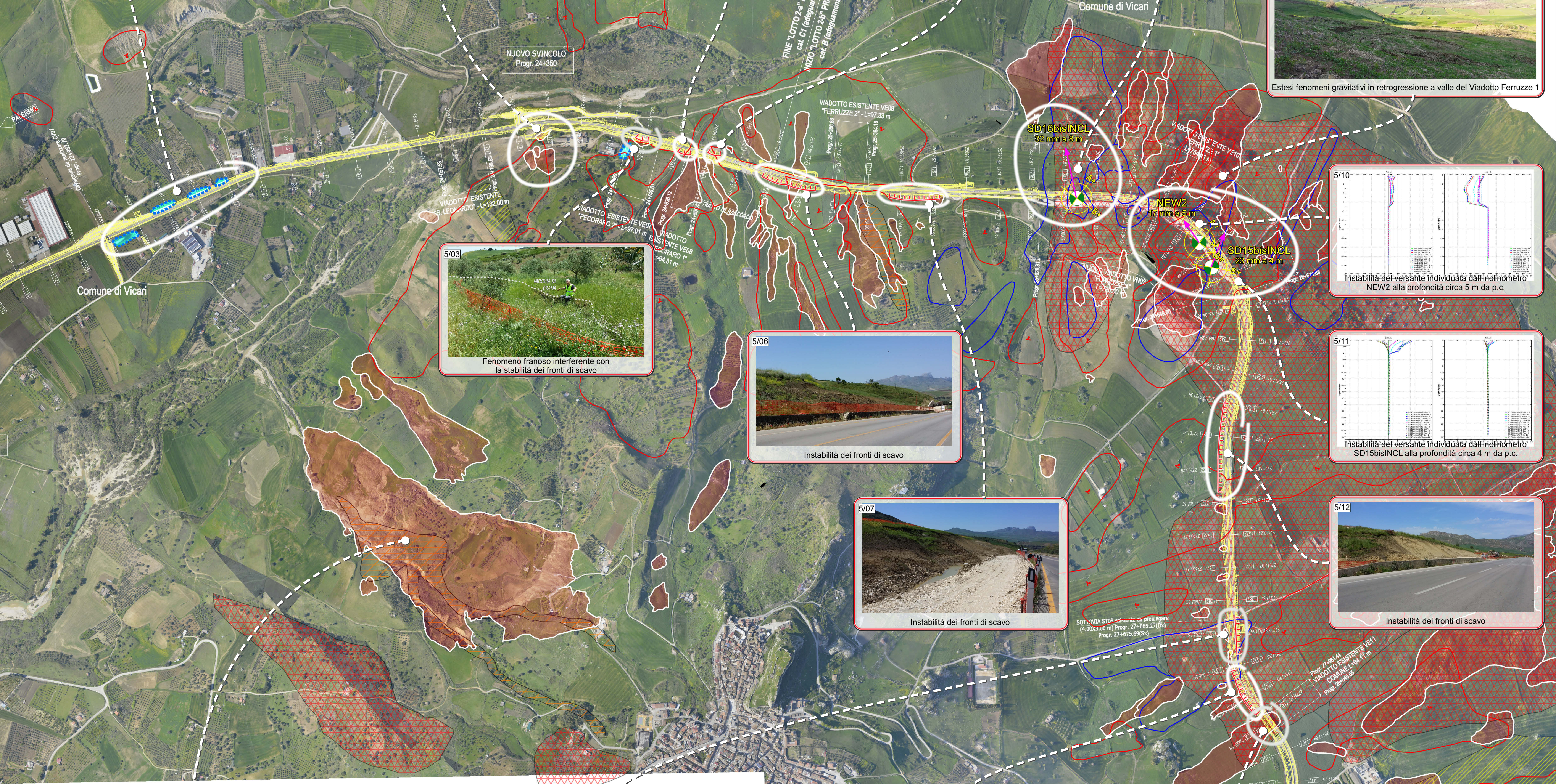
5/01 Livelli di falda freatica a quote prossime al piano campagna con diffuse emergenze e ristagni idrici interferenti con il piano di posa dei rilevati
