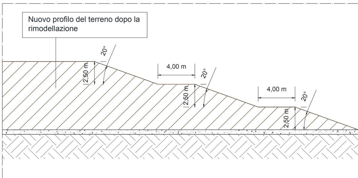
Una volta determinato il profilo di progetto nella singola sezione è stata calcolata la superficie del ricolmo nella singola sezione.
