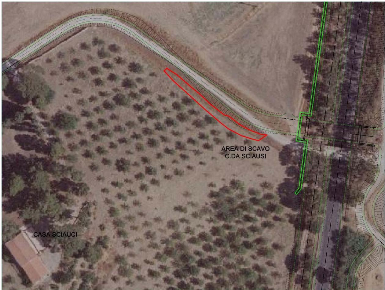
Fig. 2. Dettaglio dei limiti dell'area di scavo (in rosso) e del progetto relativo alla V.S.49 e alla SS.121
