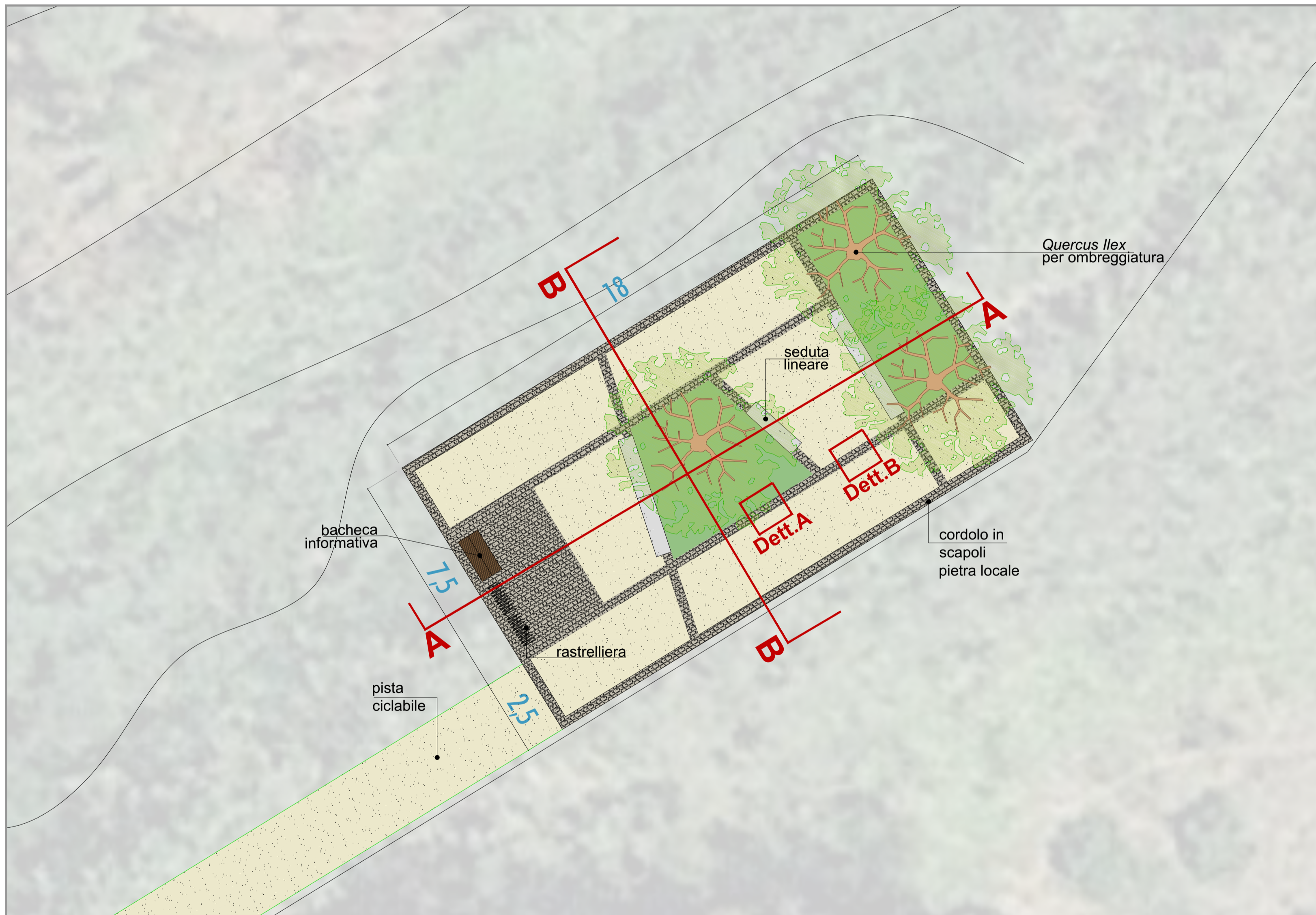
PLANIMETRIA AREA DI SOSTA CON TIPOLOGIA A - SEDUTA LINEARE Scala 1:100
