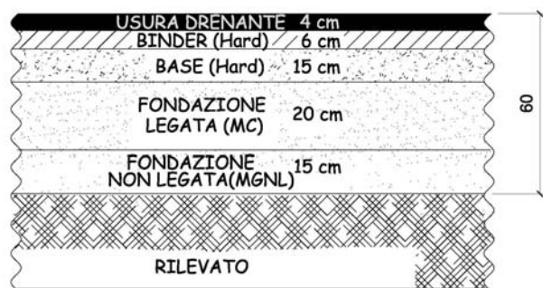
Figura 19 – Sovrastruttura nuove pavimentazioni
