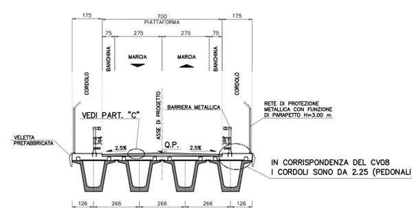
SEZIONE TIPO VIAB. INTERFERENTI IN SOTTOVIA
