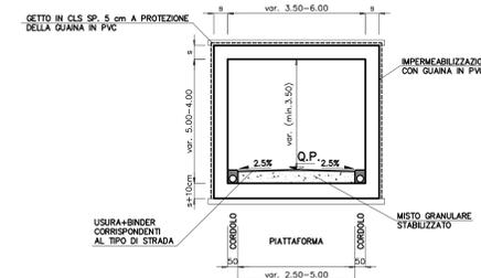
SEZIONE TIPO ROTATORIA TIPO
