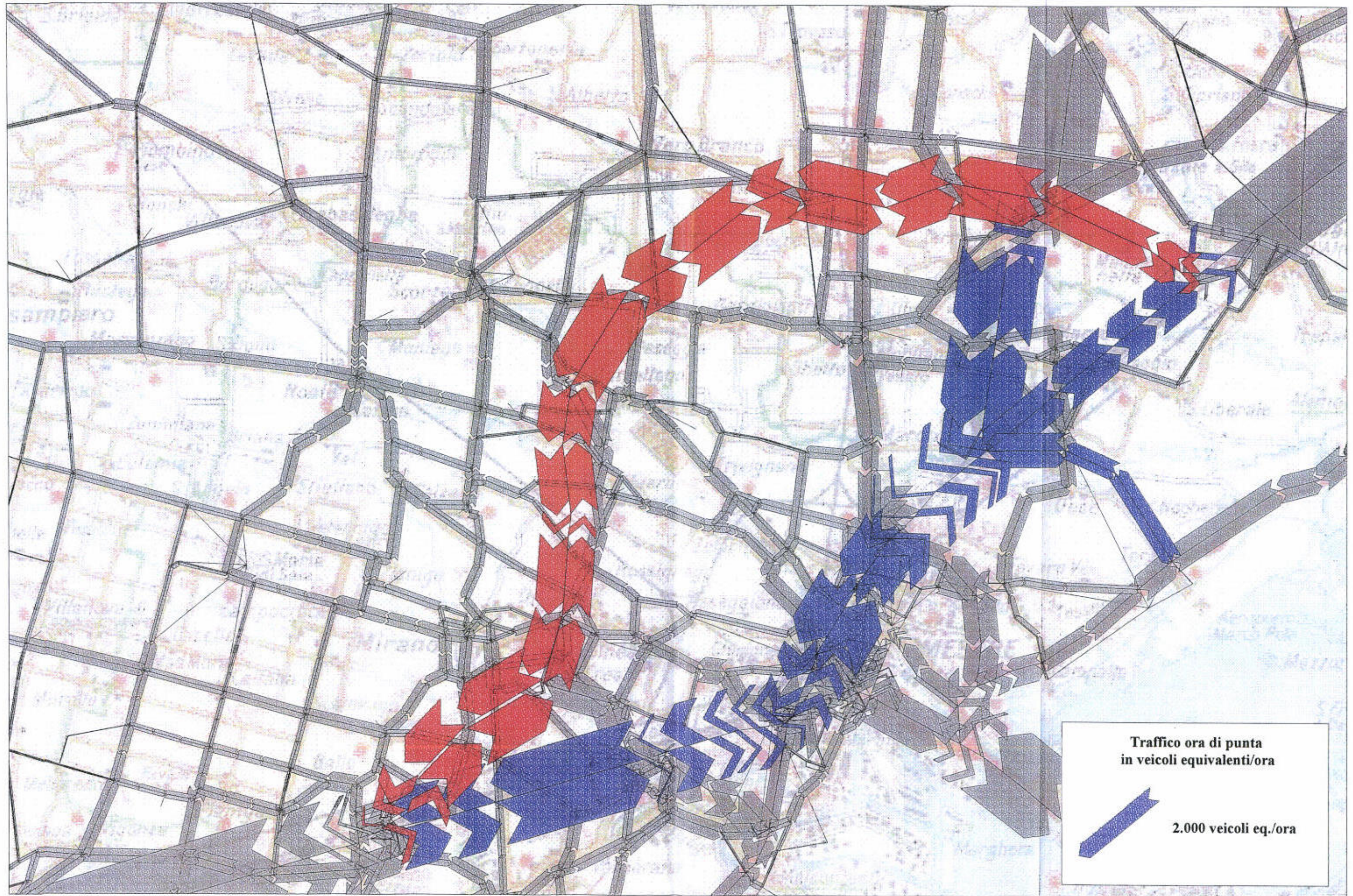
Fig. 5.2 Passante di Mestre anno 2020 - Flussogramma scenario di domanda alto - Valore del tempo incrementato del 30% (veicoli equivalenti/ora)
