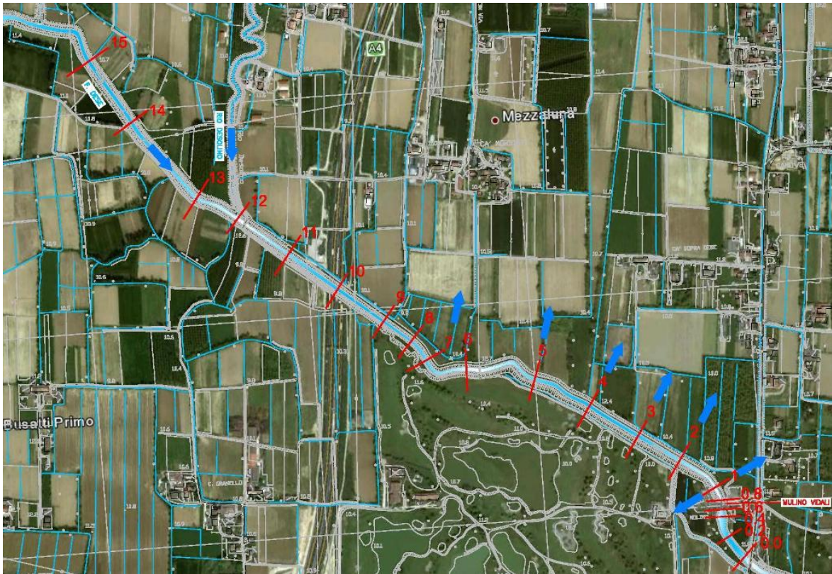
Figura 28- Stralcio di ortofoto con indicazione dei punti di sovrizzo arginale per il passaggio di un'onda di piena centenaria nella condizione attuale del corso d'acqua
