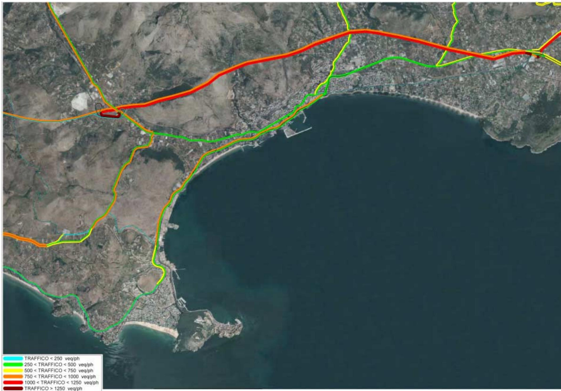
Distribuzione dell'indice di saturazione della rete (Flusso/Capacità) - SCENARIO PROGETTUALE 2010
