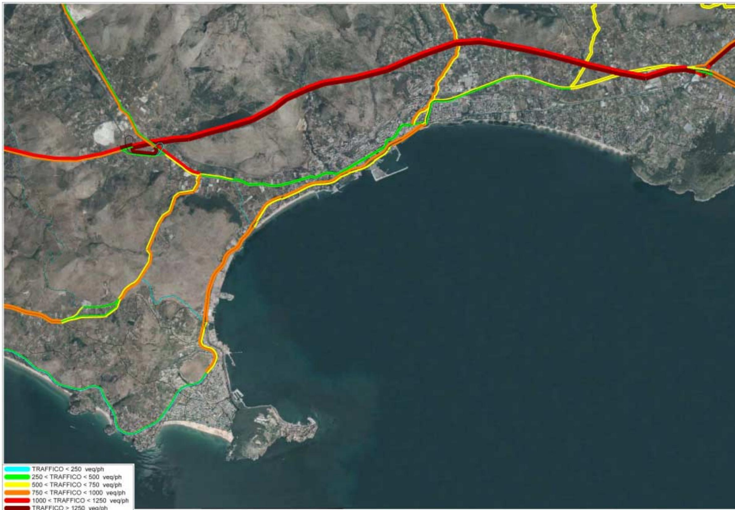
Distribuzione dell'indice di saturazione della rete (Flusso/Capacità) - SCENARIO PROGETTUALE 2030
