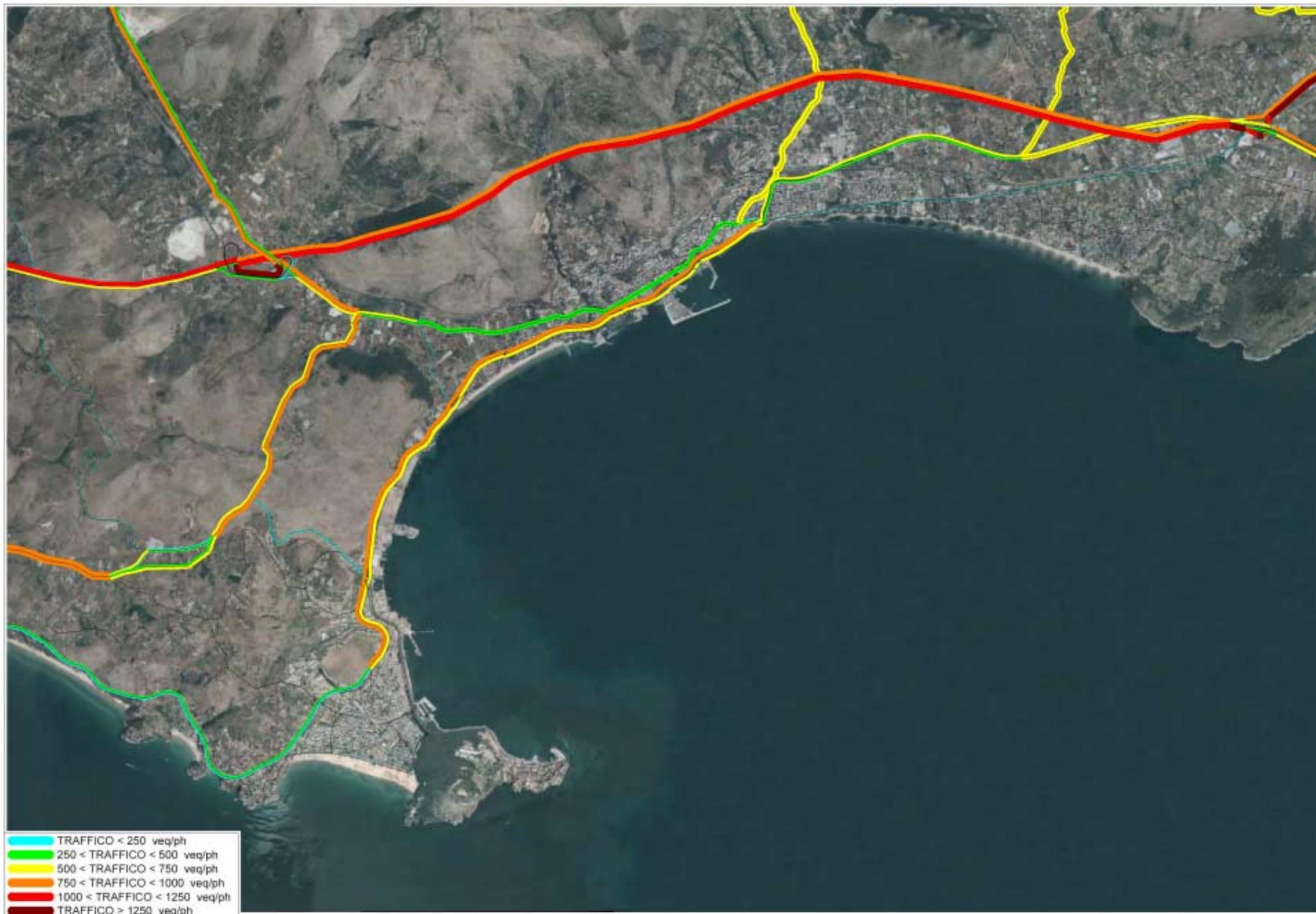
Distribuzione dell'indice di saturazione della rete (Flusso/Capacità) - SCENARIO PROGETTUALE 2020
