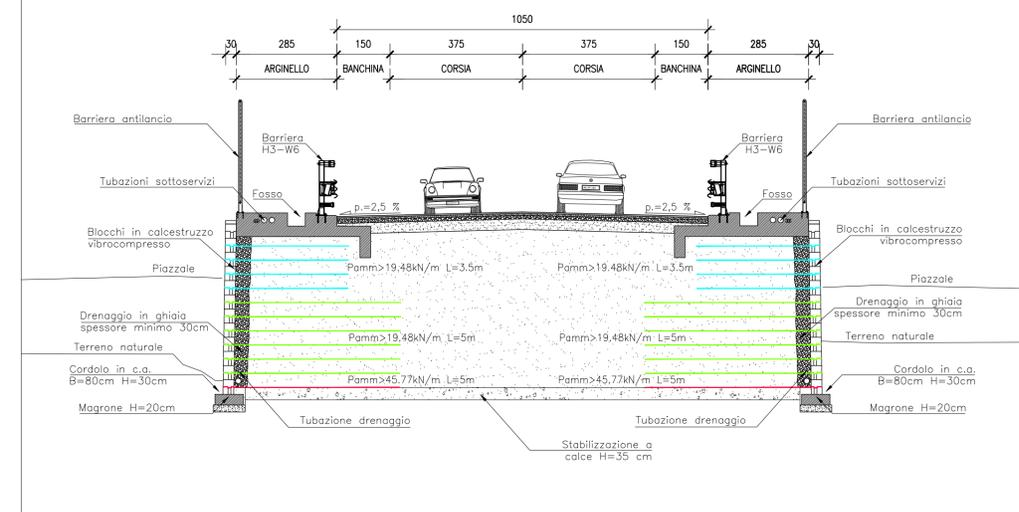
SEZIONE TU1 IN RILEVATO
