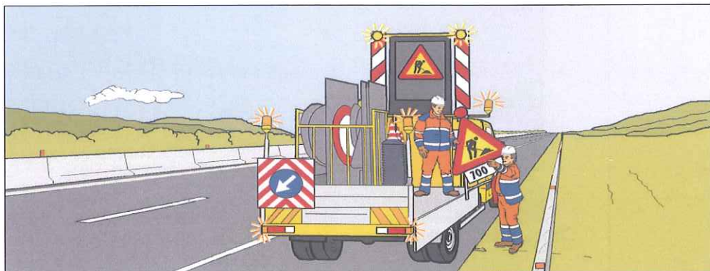
Chiusura della corsia di marcia: Scarico e installazione del segnale lavori sul margine destro
