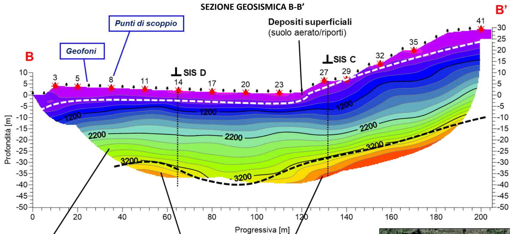
**Depositi grossolani** (ghiaie e trovanti in matrice sabbiosa) con grado di addensamento crescente con la profondità
