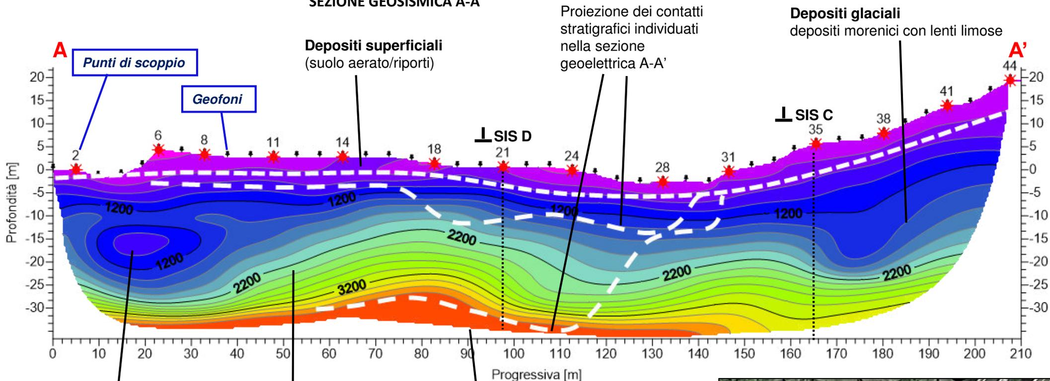
Inversione di velocità (riduzione del grado di addensamento) nei depositi grossolani
