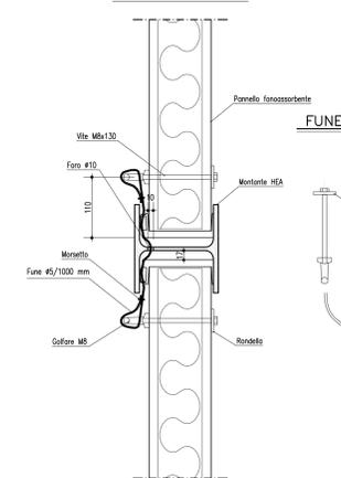
**SEZIONE ORIZZONTALE AGGANCIO DEL PANNELLO IN PMMA AL MONTANTE HEA**
