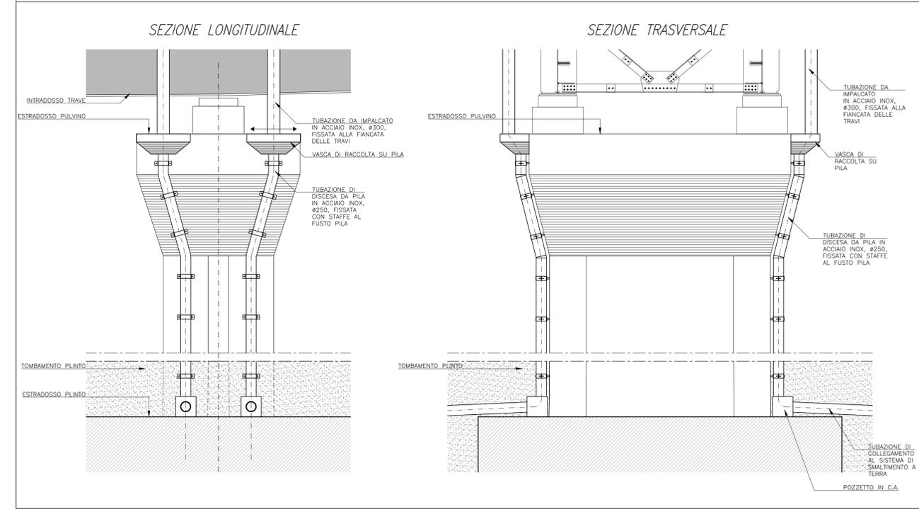
PARTICOLARE SCARICO ACQUE RILEVATO TERRA ARMATA
