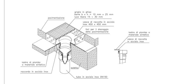
PARTICOLARE DISCESE IN CORRISPONDENZA DELLE PILE (IP1, UP2)
