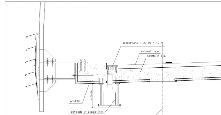
PARTICOLARE griglia di raccolta e bocchettone di scarico
