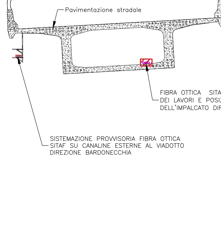
Particolare canaline scala 1:10 impalcato direzione Bardonecchia
