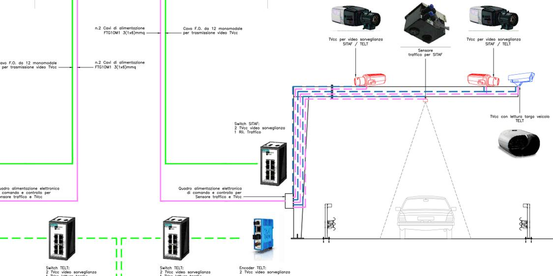
Cavi F.O. da 12 monomodale per trasmissione video TVcc alla control room di cantiere
