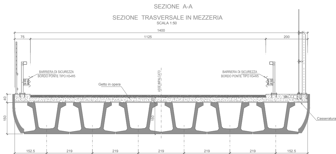
Figura 11.2 – Sezione trasversale Viadotto Mason Pianezze asse Sud
