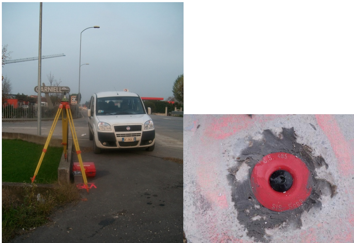
Figura 7.2– immagini dei manufatti utilizzati e tipologico caposaldo
