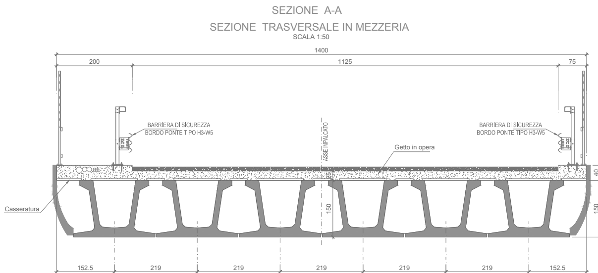
Figura 11.1 – Sezione trasversale Viadotto Mason Pianezze asse Nord
