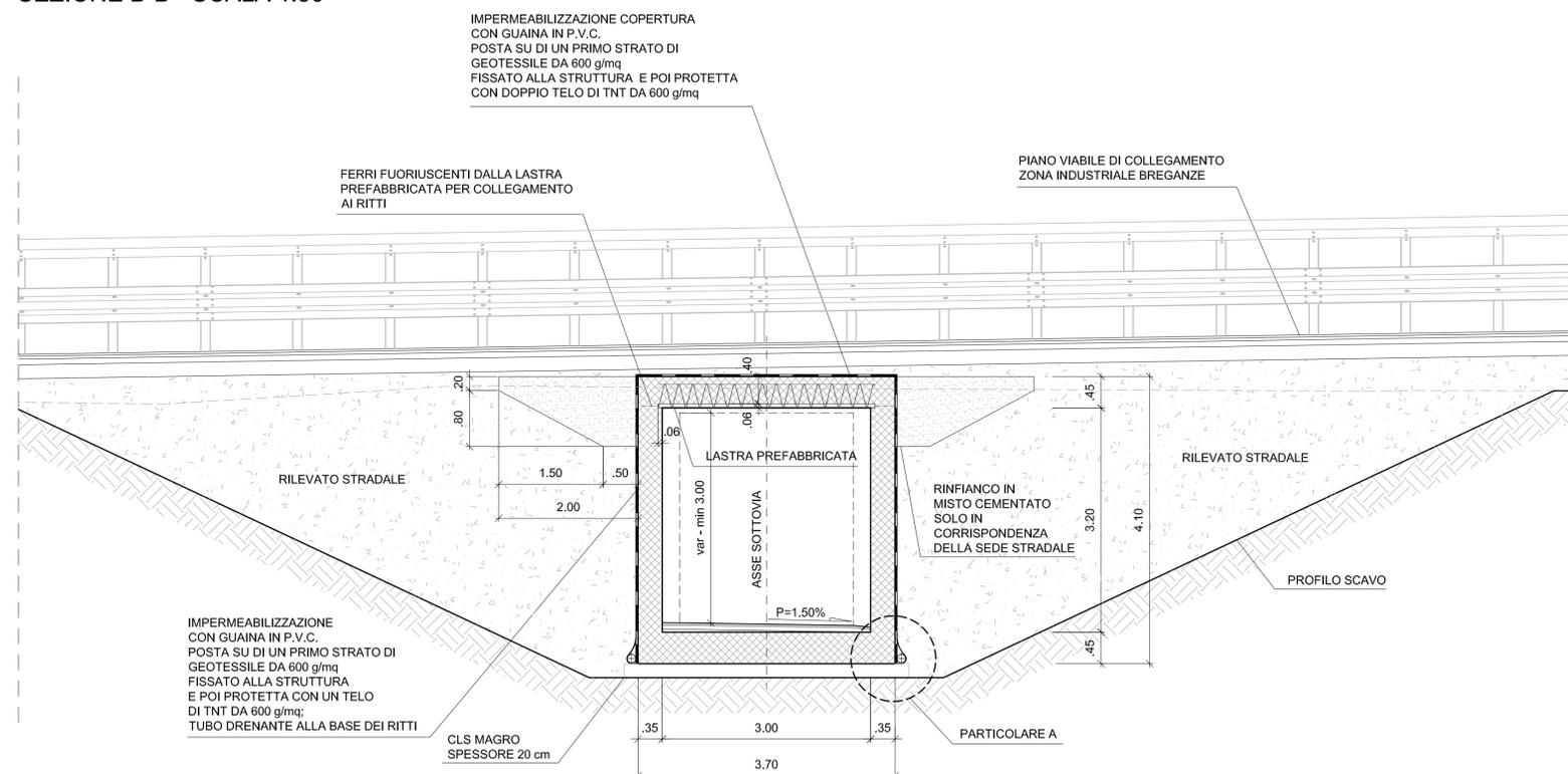
ESEGUIRE IL RILEVATO STRADALE IN STRATI COMPATTATI SIMMETRICAMENTE SU ENTRAMBI I LATI DELLO SCATOLARE
