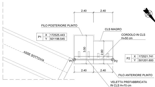
SEZIONE TRASVERSALE CORRENTE - SCALA 1:100
