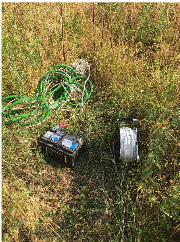
Fig. 1 Fase di allestimento prova di emungimento
