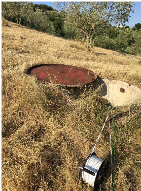
Fig. 1 Fase di allestimento prova di emungimento
