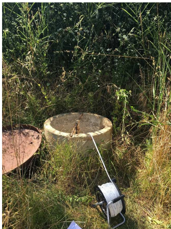
Fig. 1 Fase di allestimento prova di emungimento
