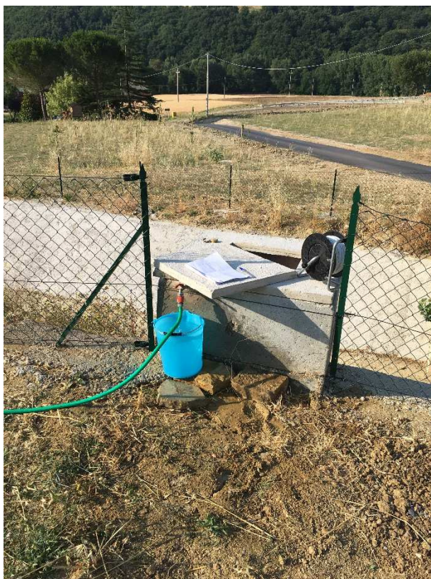
Fig. 1 Fase di allestimento prova di emungimento
