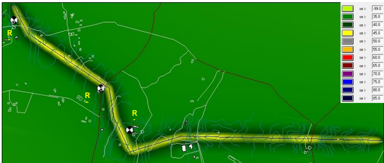
Fig. 18: Mappatura acustica emissioni post operam - Sotto Zona D Loc. Via di Porta Medaglia
