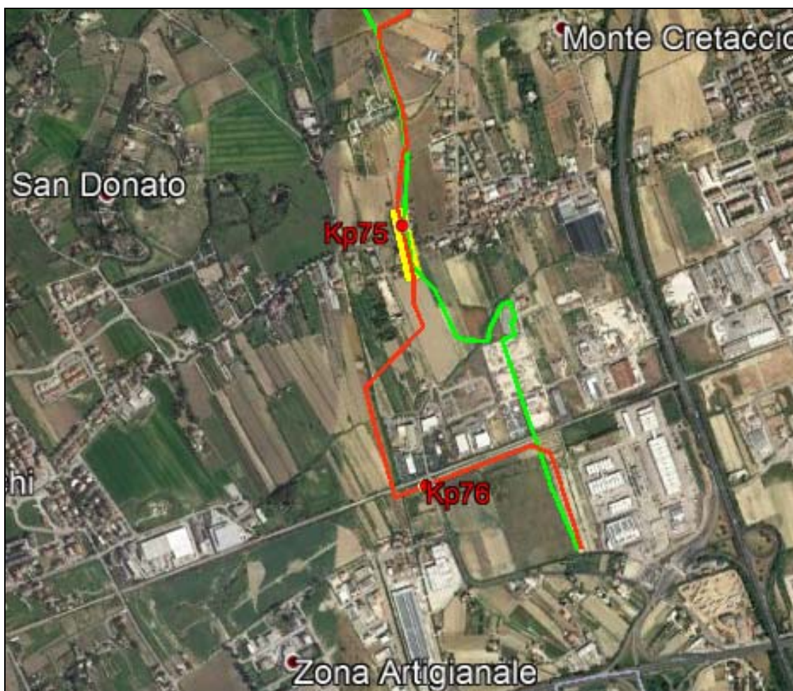
Fig. 1.5/O: Comuni di San Benedetto del Tronto e Montepreandone - inquadramento territoriale dei tracciati in progetto (rosso), in dismissione (verde) e tratti trenchless (giallo)
