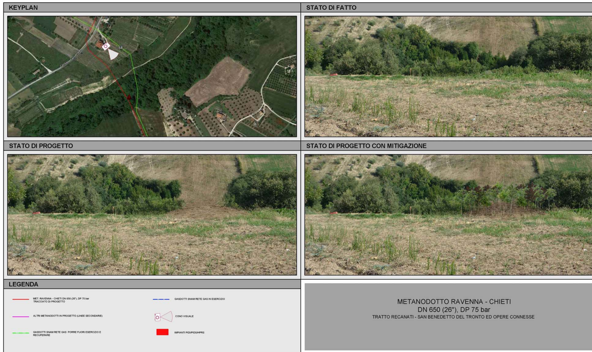
Fig. 2.1/E: Esempio di ripristino morfologico e vegetazionale dell'area di passaggio
