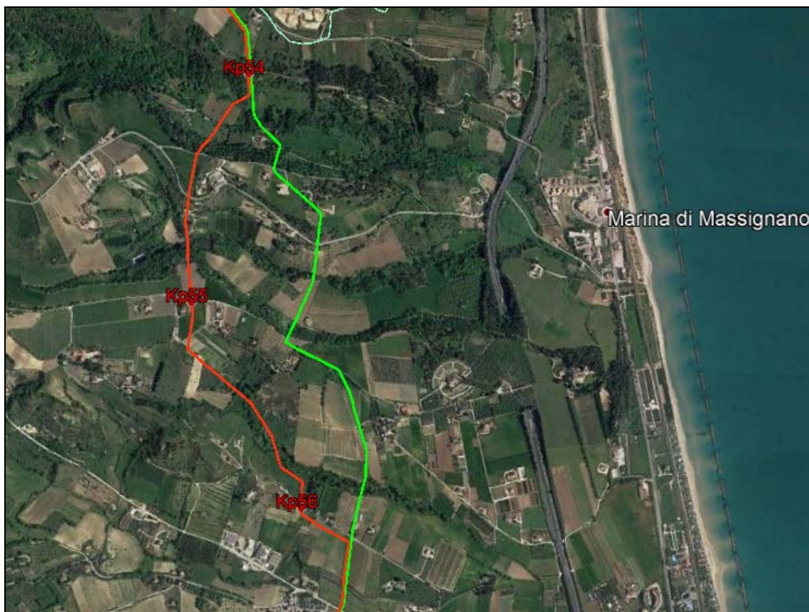
Fig. 1.5/I: Comuni di Massignano e Cupra Marittima - inquadramento territoriale dei tracciati in progetto (rosso), in dismissione (verde) e tratti trenchless (giallo)
