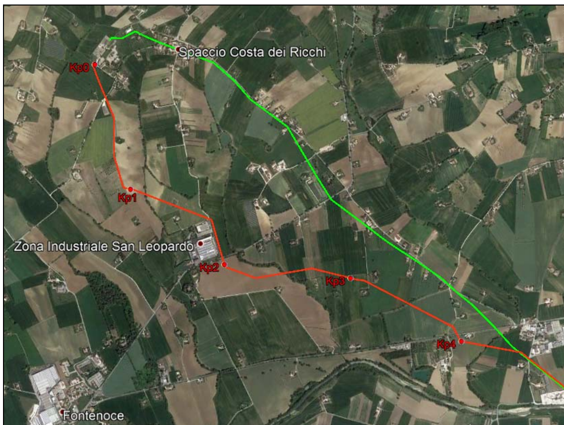
Fig. 1.5/B: Comune di Recanati, Loc. “C. Mattonata” - inquadramento territoriale dei tracciati in progetto (rosso) e in dismissione (verde)
