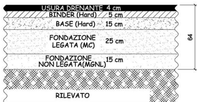
Figura 8 – Sovrastruttura nuove pavimentazioni
