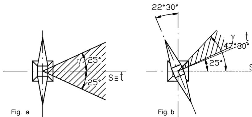
NOTA: In ogni caso non si supera mai un angolo di deviazione di  $25^{\circ}$  rispetto all'asse "t" normale al piano della finestra del sostegno.
