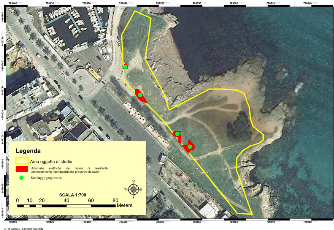
Ubicazione sondaggi geognostici da eseguire
