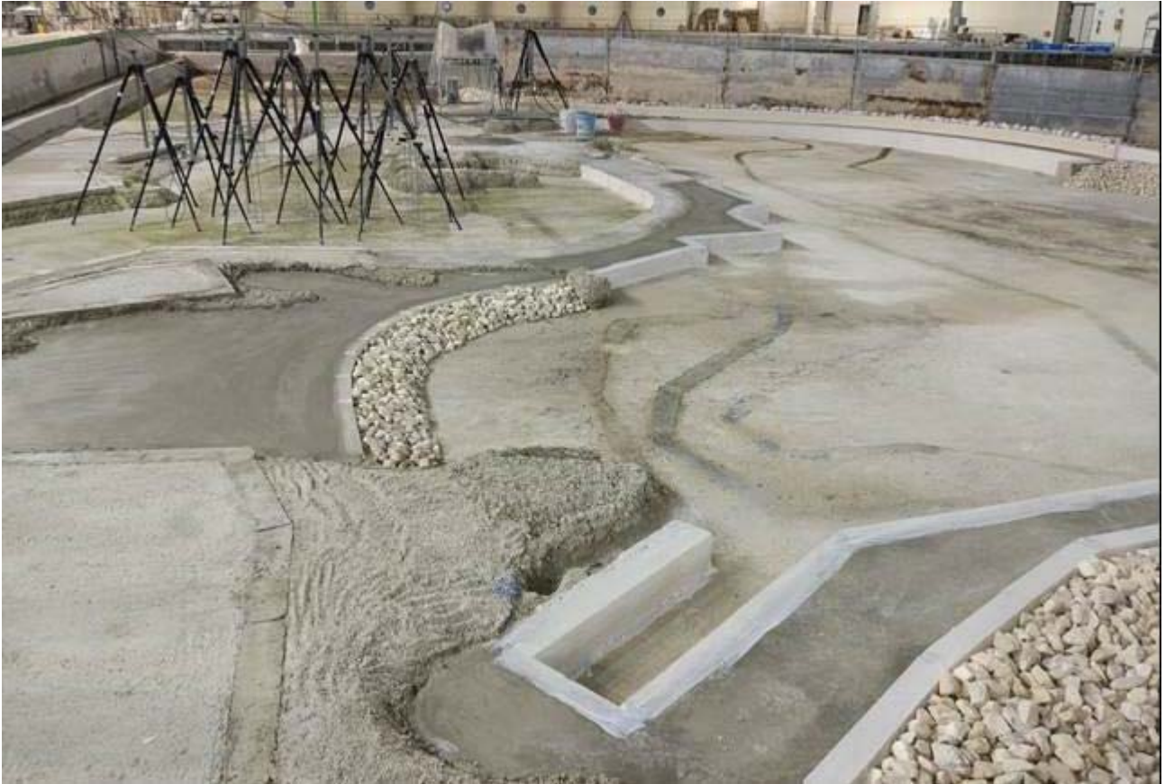
Fig. 6.3.1.13: completamento del tratto di costa a nord del molo di sottoflutto
