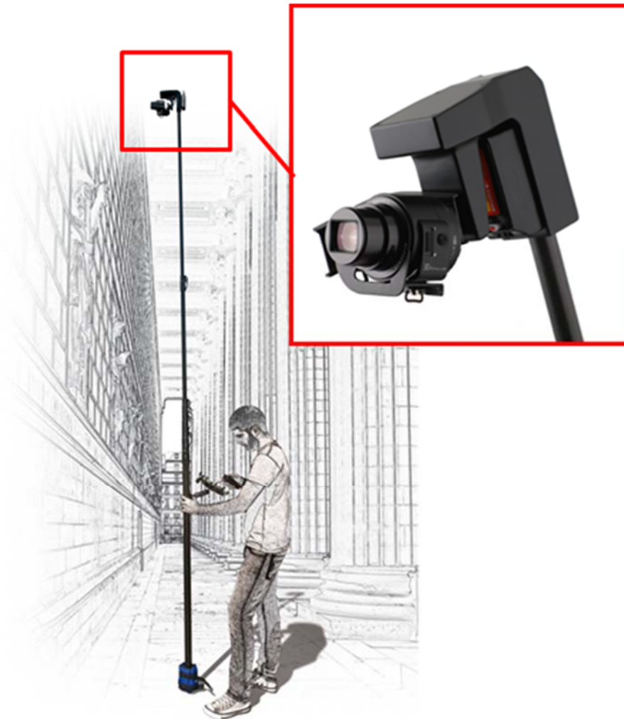
Fig. 4.3.4: il 3DEYE usato per il rilievo fotogrammetrico
