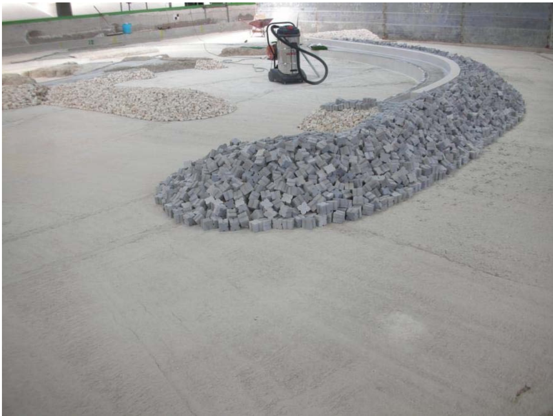
Fig. 2.41: fase costruzione del modello: completamento del molo di sopraflutto, con posa in opera dei blocchi artificiali "Antifer".
