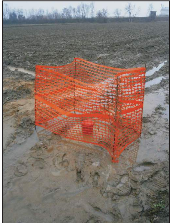
Foro attrezzato con piezometro
