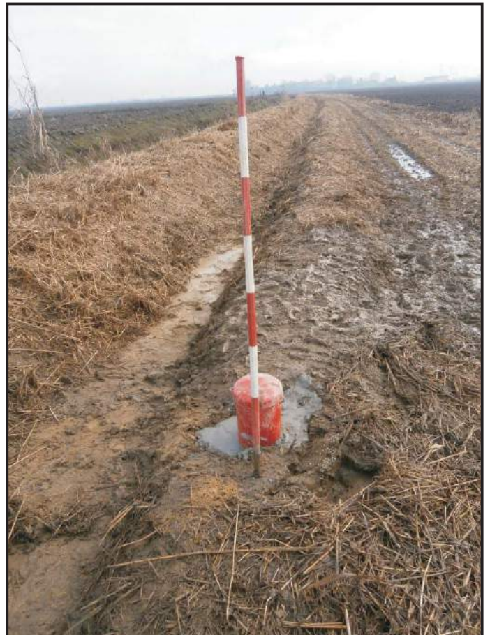
Foro attrezzato con piezometro
